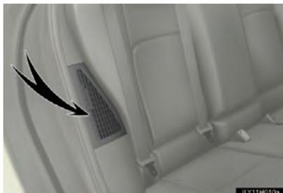
Há uma entrada de ar na lateral direita do encosto do banco traseiro com o propósito de refrigerar a bateria híbrida (bateria de tração). Se a passagem de ar for bloqueada, a bateria híbrida pode superaquecer, levando a uma redução de potência na bateria híbrida.
