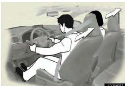
O pré-tensionador ajuda o cinto de segurança a conter rapidamente o ocupante retraindo o cinto quando o veículo estiver sujeito a determinados tipos de colisões frontais e laterais severas.
