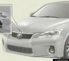
Levante a alavanca auxiliar e a seguir o capô.
