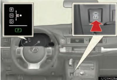
Pare o veículo completamente e acione o freio de estacionamento, em seguida aperte o interruptor da posição em P.
