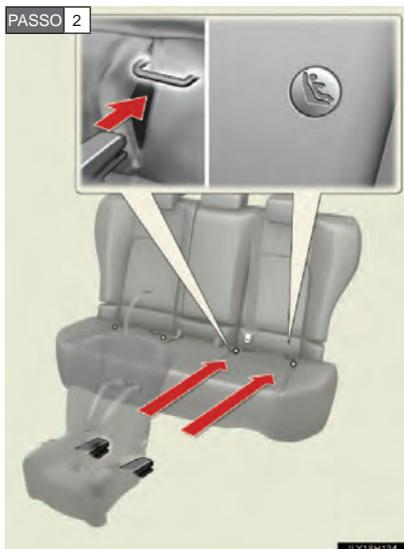
Ajuste o apoio de cabeça para a posição mais alta. Verifique as posições das barras de fixação próprias, e instale o sistema de segurança para crianças no banco.
