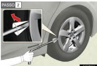
Para veículos com pneus aro 15, remova a calota com uma chave inglesa.
