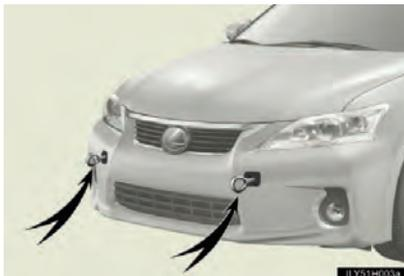
Se um guincho não estiver disponível em um caso de emergência, caso a legislação local permita, seu veículo pode ser rebocado temporariamente por meio de um cabo ou uma corrente presos ao(s) olhal(is) de reboque de emergência. Este método deve ser realizado apenas em vias pavimentadas, em distâncias curtas e abaixo de 30 km/h.
