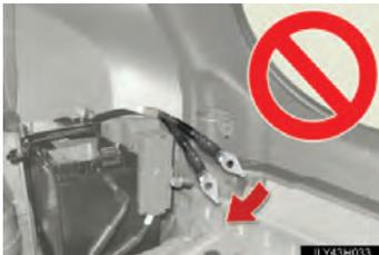
Não desconecte o terminal negativo (-) na lateral do corpo, como mostrado. O terminal negativo (-) desconectado pode tocar o terminal positivo (+), o que pode causar um curto e resultar em ferimentos graves ou fatais.
