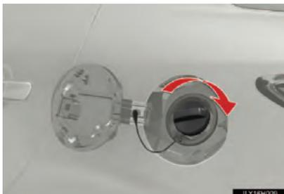
Após reabastecer, gire a tampa do tanque de combustível até ouvir um clique. Uma vez que a tampa é solta, ela irá girar levemente na direção oposta.
