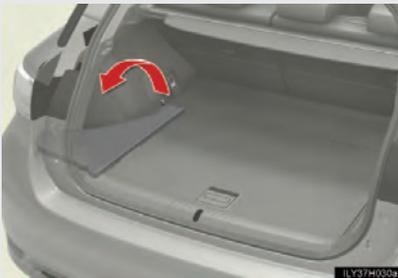
Levante a caixa auxiliar lateral esquerda.
