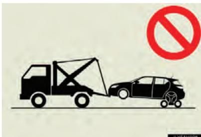
Não faça o reboque utilizando um caminhão tipo guincho a fim de evitar danos à carroceria.
