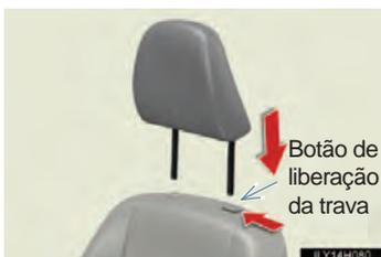
Alinhe o apoio de cabeça com os furos de instalação e empurre-o para baixo, até a posição de travamento.
