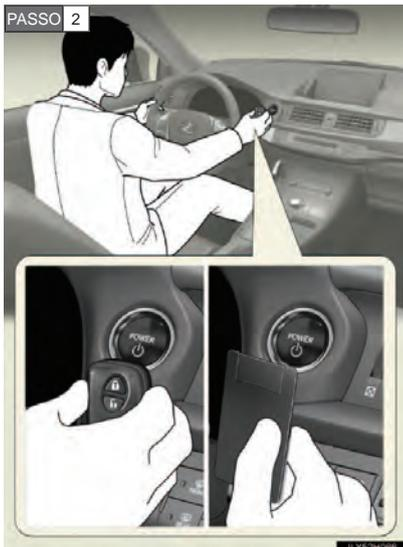
Toque a lateral do emblema da Lexus da chave eletrônica para o interruptor "POWER".
