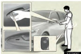
Se a porta não travar quando o sensor da parte superior for tocado, tente tocar as áreas do sensor superior e inferior ao mesmo tempo.
