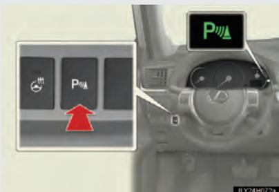
Liga/desliga o sensor de auxílio a estacionamento Lexus
