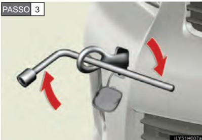
Aperte o olhal de reboque firmemente com uma chave de rodas.
