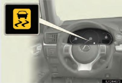
Para executar o controle de suporte a partidas em acrive, pressione o pedal do freio quando o veículo estiver completamente parado.
