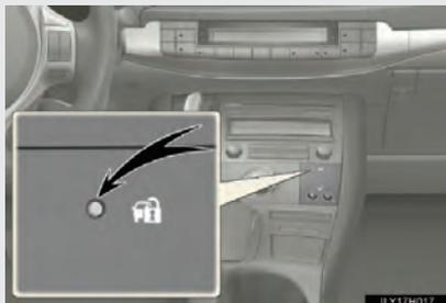
A luz indicadora pisca após o interruptor “POWER” ter sido desligado para indicar que o sistema está funcionando.
