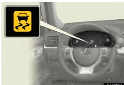
Se o veículo correr o risco de derrapar ou das rodas girarem, as luzes do indicador de derrapagem piscarão para indicar que os sistemas de VSC/TRC estão operando.
