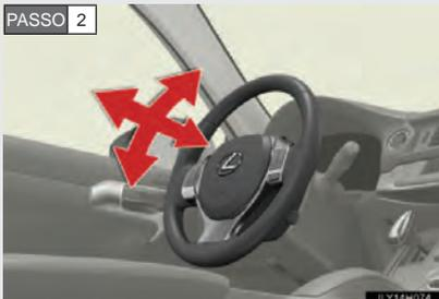
Ajuste até a posição ideal movendo o volante horizontalmente e verticalmente.
