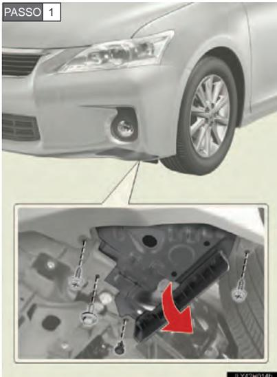
Remova duas porcas, um parafuso e um clipe, e abaixe a tampa de baixa do motor.
