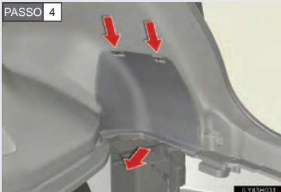
Remova a tampa de manutenção da bateria de 12 volts.
