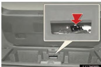
Levante a caixa auxiliar central e então empurre para baixo a alavanca no buraco.
