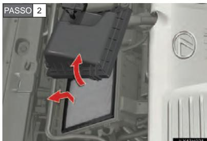
Levante a tampa e retire o filtro do limpador de ar.
