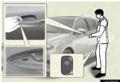
Toque no sensor de trava (na parte superior da maçaneta) para travar as portas.
