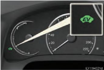
O Indicador de EV se acende ao dirigir o veículo utilizando apenas o motor elétrico (motor de tração).
